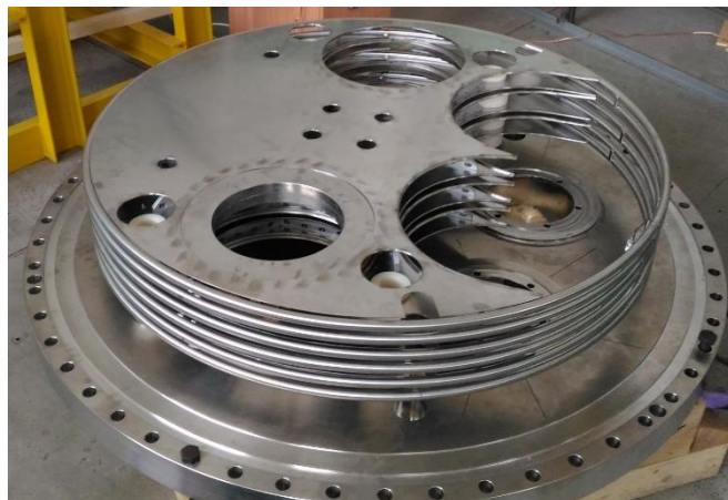
Секции электростатического ускорителя
