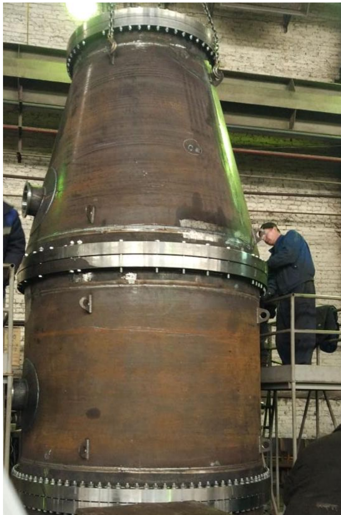
Сосуд для электростатического ускорителя в процессе производства
