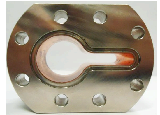
Фланцевые соединения сохраняющие «гладкость» камеры пучка
