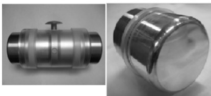
Рис. 1. Фотографии разрядника отрицательных импульсов.
