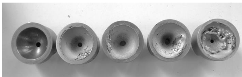
Рис. 4. Фотография молибденовых катодов. Продолжительность непрерывной работы, слева направо: новый, 300 с, 600 с, 1300 с, 2600 с.
