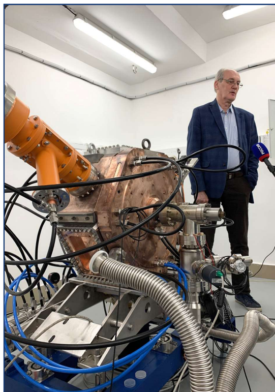
Е. Б. Левичев на фоне высокочастотного резонатора, отвечающего за ускорение электронов в бустере СКИФ и изготовленного в ИЯФ. Фото Ю. Клюшниковой.
