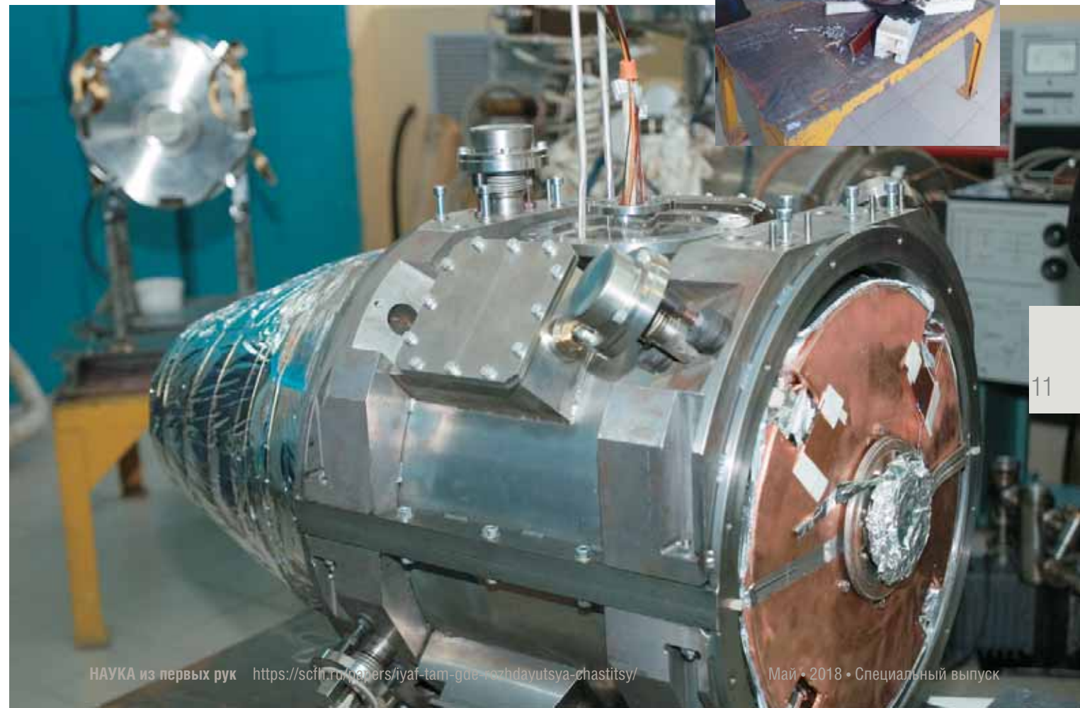
Сверхпроводящие соленоиды работают при очень низкой температуре, поэтому у каждого их блока есть буферный объем емкостью 200 л для хранения жидкого гелия (его температура — 4 °K или — 269 °C)
