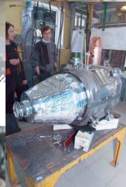
Сверхпроводящие соленоиды работают при очень низкой температуре, поэтому у каждого их блока есть буферный объем емкостью 200 л для хранения жидкого гелия (его температура — 4 °K или — 269 °C)
